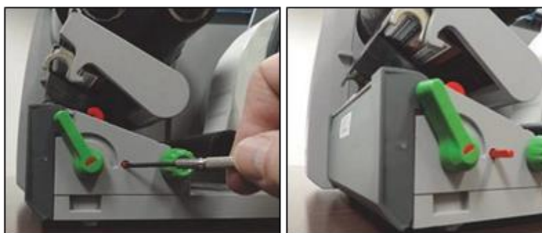
Figure 9- 7 : Réglage du capteur d'étiquettes
