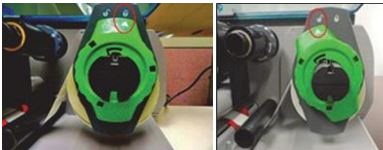
Figure 9- 2 : Tourner la bague de maintien
