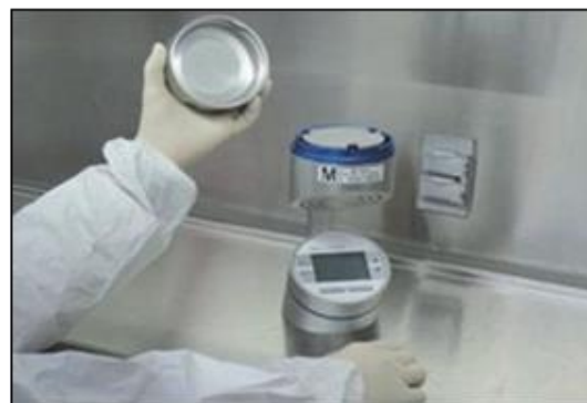
Figure 7- 5 : Mise en place de la cassette dans l'échantillonneur
