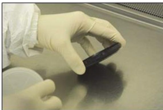
Figure 7- 8 : Technique de roulement
