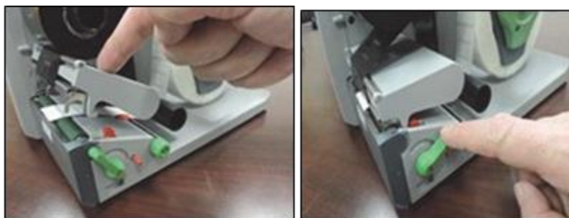
Figure 9- 16 : Verrouillage de la tête d'impression en place
