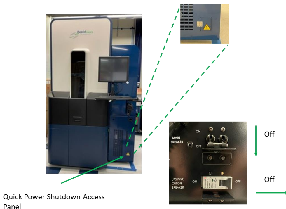
Figure 10- 5 : Panneau d'accès à l'arrêt rapide de Growth Direct®
