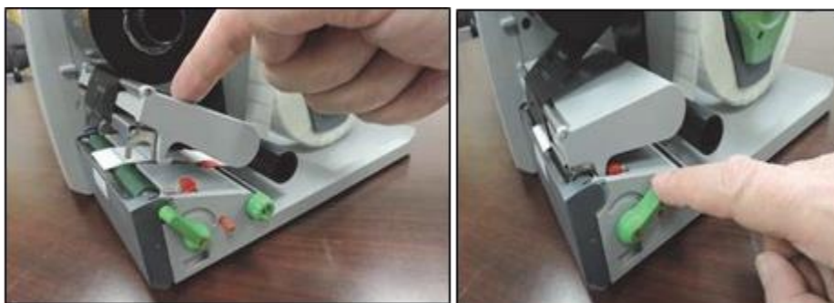
Figure 9- 8 : Verrouillage de la tête d'impression
