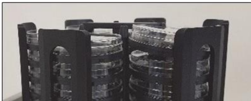
Figure 6- 10 : Cassette mal alignée dans le carrousel
