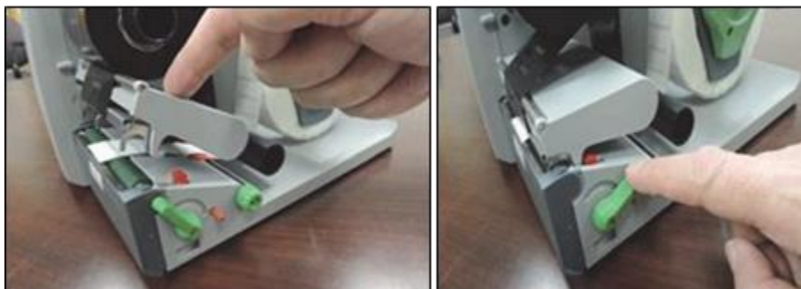
Figure 9- 14 : Réglage du levier de déverrouillage de l'impression
