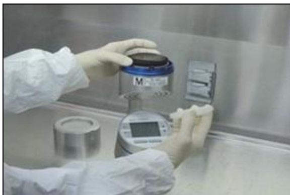
Figure 7- 6 : Retrait du capot de protection
