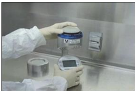
Figure 7- 5 : Mise en place de la cassette dans l'échantillonneur
