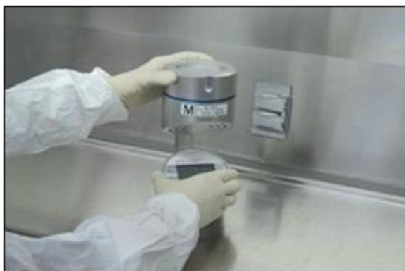
Figure 7- 7 : Vissage du couvercle de l'échantillonneur d'air
