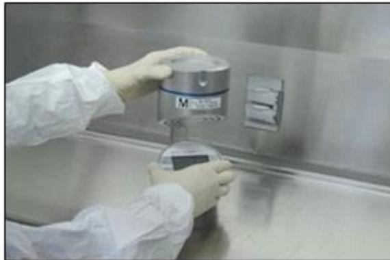
**Figura 7-7: Enroscado en la tapa del muestreador de aire**
