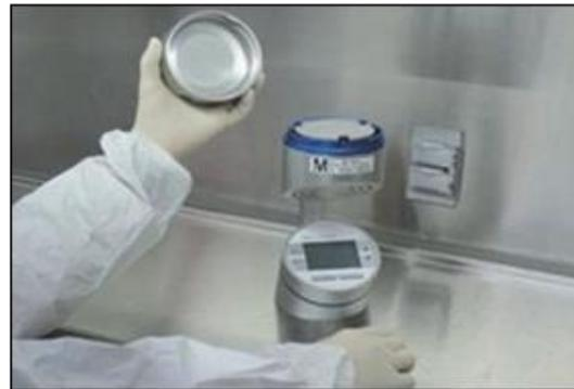
Figura 7-5: Colocación del cartucho en el muestreador
