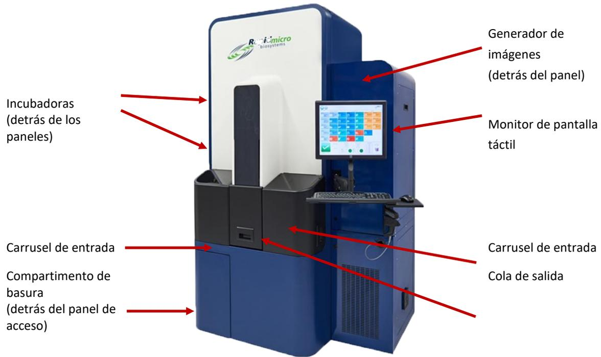
Figura 1-1: Dispositivo Growth Direct®
