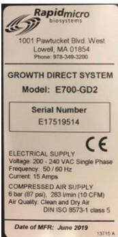
**Etiqueta del dispositivo.** Indica el número de modelo, el número de serie, las características del suministro eléctrico (voltaje, frecuencia, corriente), las características del suministro de aire comprimido y la fecha de fabricación del sistema.
