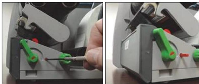
**Figura 9-7: Ajuste del sensor de etiquetas**
