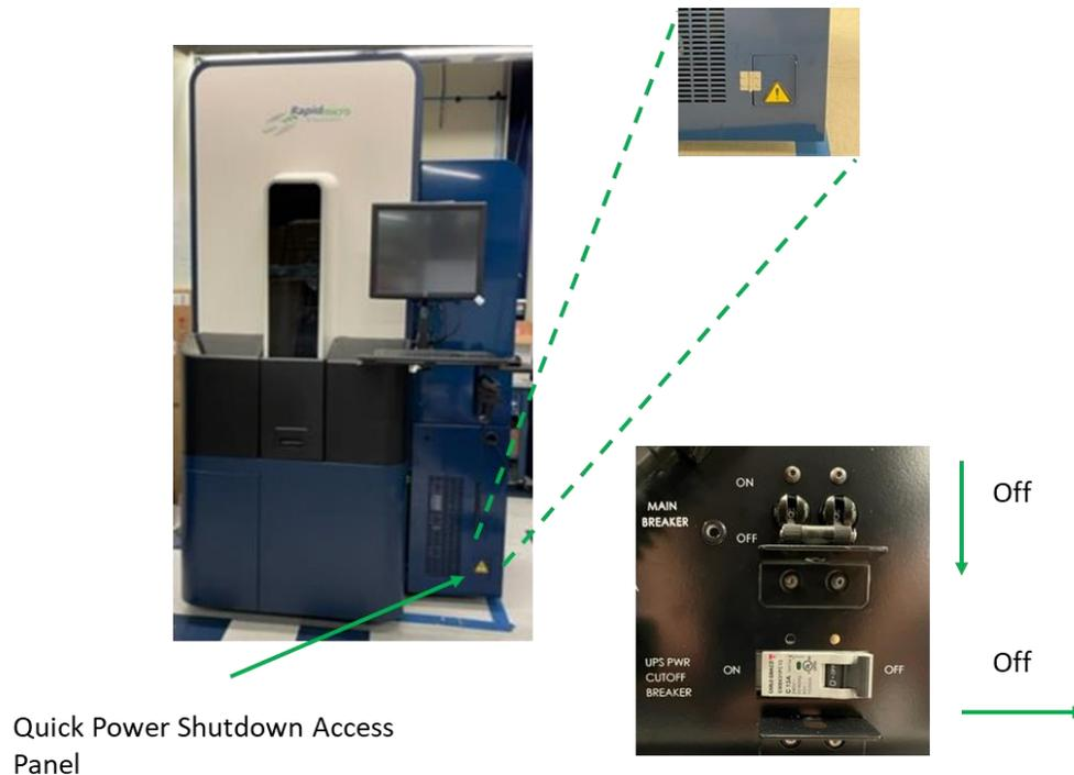
Figura 10-5: Panel de acceso de apagado rápido de Growth Direct
