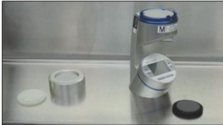
Figura 7-4: Muestreadores de aire y sujeciones de adaptador
