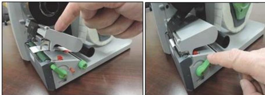
Abbildung 9-8: Verriegeln des Druckkopfs
