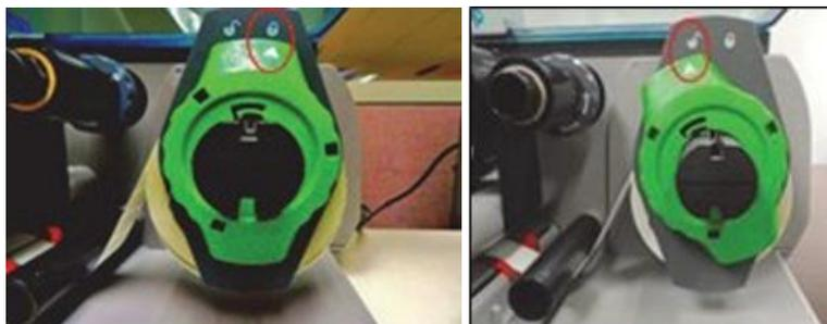
Abbildung 9-2: Drehen Sie den Haltering
