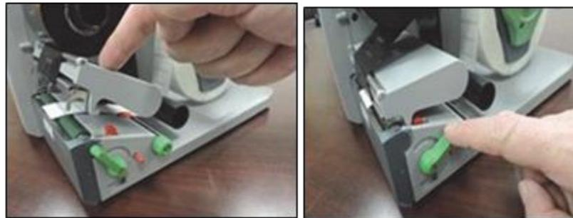
Abbildung 9-16: Verriegeln des Druckkopfs
