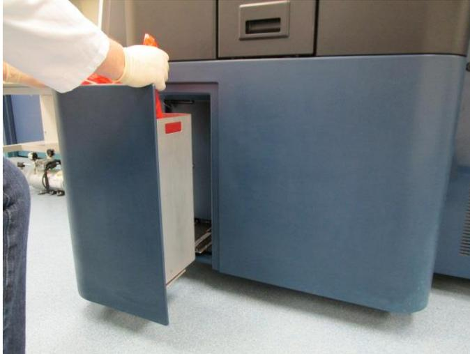
**Abbildung 3-20: Entfernen des Beutels mit Biogefahrmaterial aus dem Abfallbehälter**
