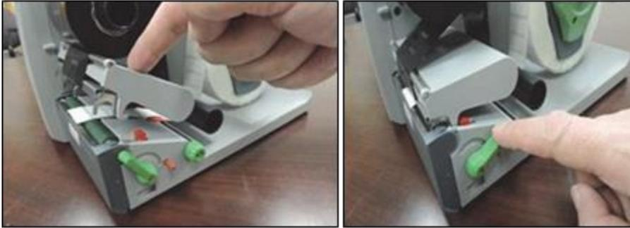
Abbildung 9-14: Einstellen des Druckentriegelungshebels
