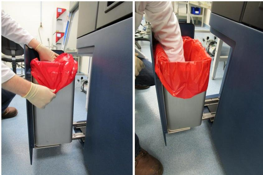
**Abbildung 3-21: Einlegen eines neuen Abfallbeutels für Biogefahrmaterial**
