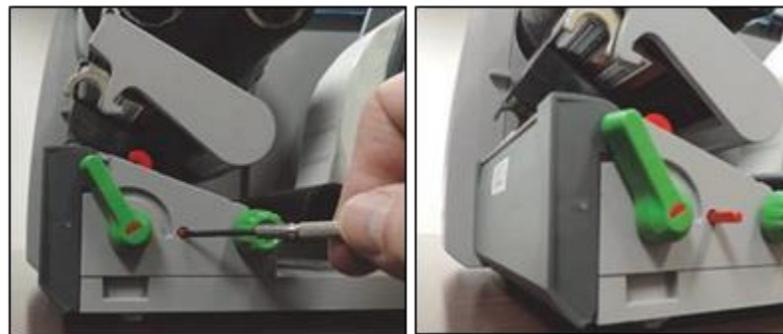
Abbildung 9-7: Einstellen des Etikettensensors
