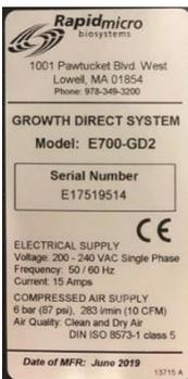
**Gerätebeschriftung.** Zeigt die Modellnummer des Systems, die Seriennummer, die Spezifikationen der Stromversorgung (Spannung, Frequenz, Strom), die Spezifikationen der Druckluftversorgung und das Herstellungsdatum an.
