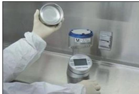
Abbildung 7-5: Einsetzen der Testkassette in den Probennehmer
