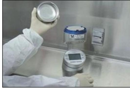
図 7-5: カセットをサンプラーにセットする
