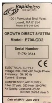
**機器ラベル。** システムのモデル番号、シリアル番号、電源の仕様（電圧、周波数、電流）、圧縮空気供給の仕様、および製造年月日を表示します。
