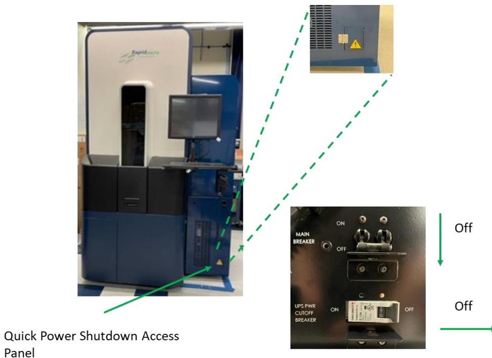
図 10-5: Growth Direct クイック電源シャットダウン用アクセスパネル
