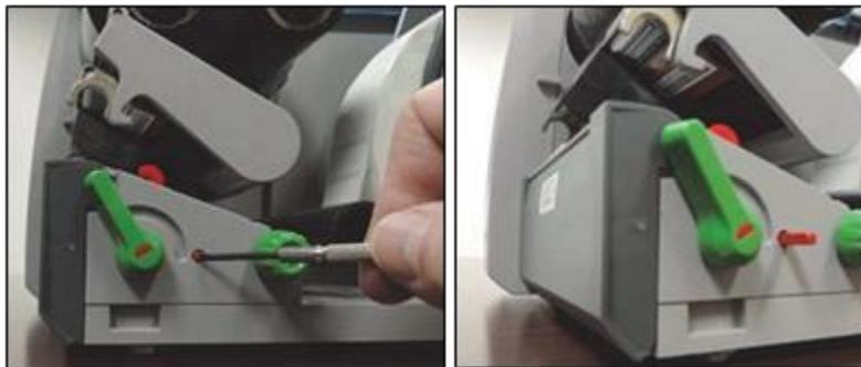
図 9-7: ラベルセンサーの調整
