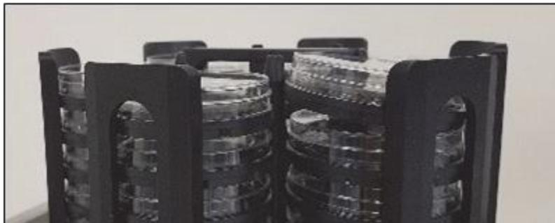
図 6-10: カルーセルでカセットが傾いている
