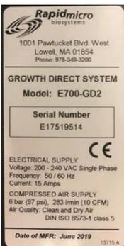
**仪器标签。** 说明系统型号、序列号、电源规格（电压、频率、电流）、压缩空气供应规格和生产日期。
