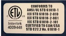
**ETL 标签。**表示该系统已经过经认证的第三方测试实验室测试，符合适用的安全标准和北美销售或分销的最低要求。
