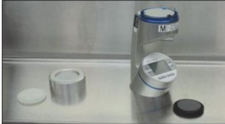
图 7-4: 空气采样器和适配器夹
