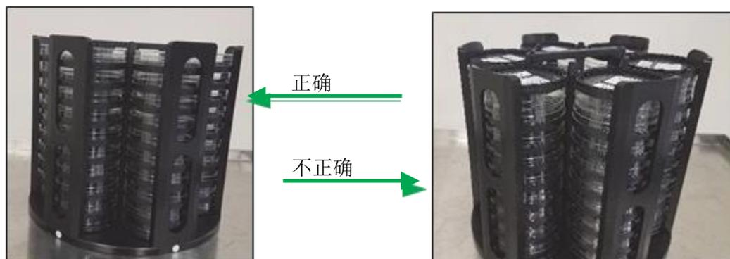
图 6-9: 已加载样品盒的透明盖朝上 (左图), 已加载样品盒的透明盖朝下 (右图)
