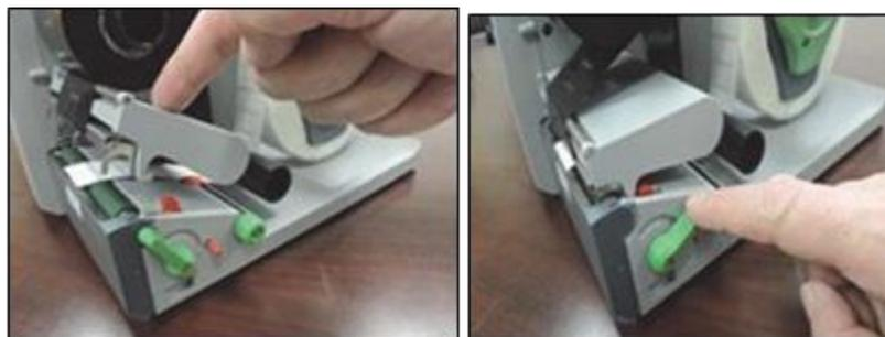
图 9-16: 将打印头锁定到位
