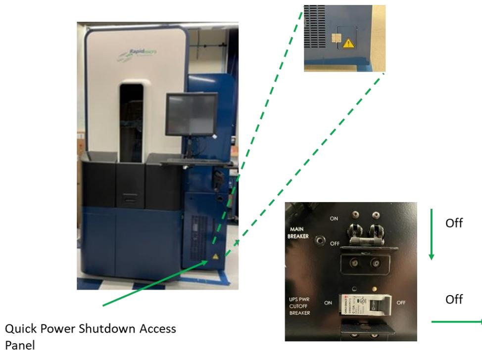
图 10 - 5: Growth Direct 快速断电访问面板
